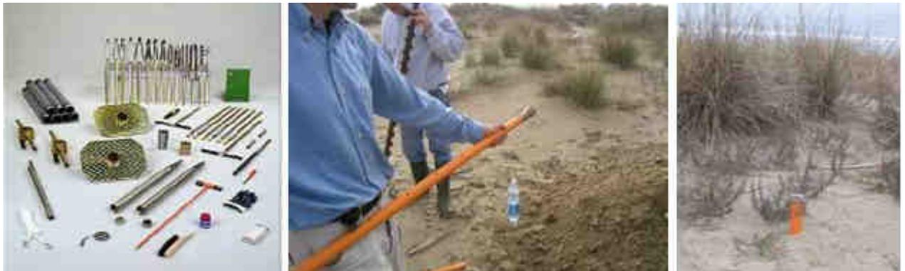
Figure 2 - A gauche (a): Système de forage type «Eijkelkamp» (NL); au milieu (b): exemple de piézomètre utilisé avec perforations chaque 25 cm; à droite (c): emplacement définitif.
