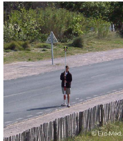
Figure 2 – opérateur tenant la canne topographique équipée d'un réflecteur.
