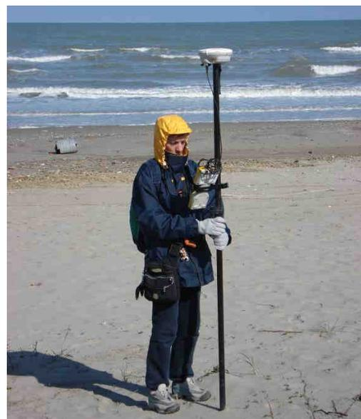
Figures 3a & 3b – Relevé topographique réalisé à l'aide d'un dGPS.
