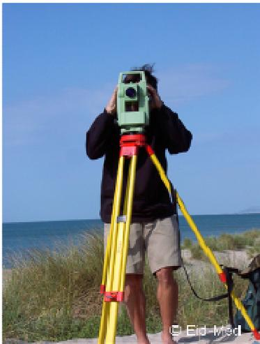
Figure 1 – opérateur utilisant la station du LEICA-TC 307.
