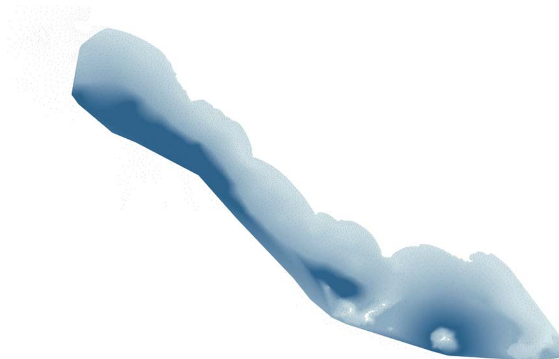
Figura 8 – Risultato dell'interpolazione dei punti quotati. Il DTM risultante ha una risoluzione pari a 20 m (celle: 20x20 m). Sebbene il contributo totale dei punti non sia sufficiente ad ottenere interpolazioni di dettaglio, risultano ben evidenti le strutture delle Isole e Pontine e la Secca di Tor Paterno.
